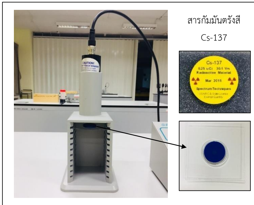
รูปที่ 12.4 การวางสารกัมมันตรังสีในชุดทดลอง
