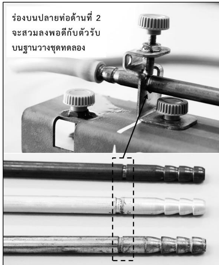
รูปที่ 8.2 การประกอบท่ออะลูมิเนียมบนฐานวางชุดทดลอง
